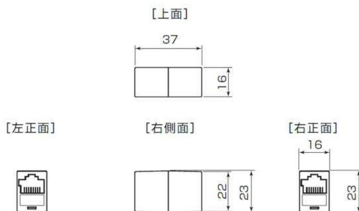
混合器 寸法図 (単位: mm)
